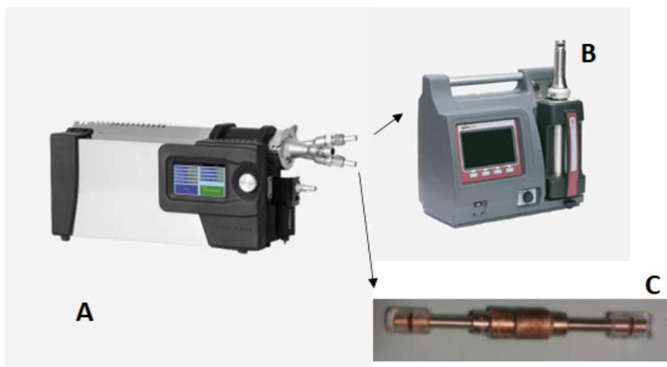
Figure 1 : Système de dilution à chaud eDilutor Pro (A) en amont d'un compteur granulométrique ELPI+ (B) et de préleveurs manuels MPS (C)
