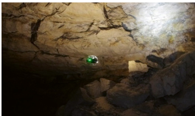
Figure 11 : levés 3D par drone volant (BRGM).
