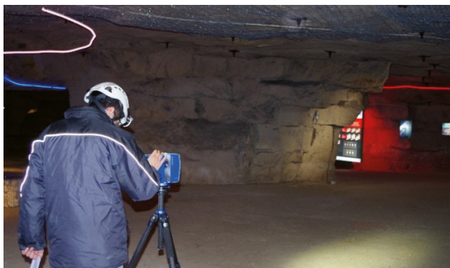
Figure 9 : levés par scanner laser terrestre d'une zone de chambres et piliers (Ineris).
