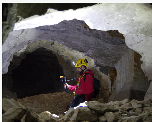
Exemple d'un scanner laser 3D mobile ZEB Revo®.
