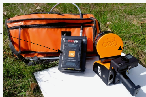
Éléments constitutifs d'un scanner laser mobile de type GeoSLAM ZEB Horizon®.
