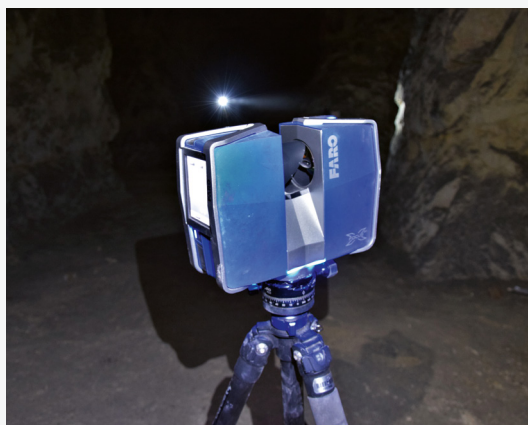
Exemple d'un scanner laser 3D terrestre sur trépied FARO Focus 3D X330.
