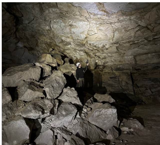
Figure 10 : levés par scanner laser mobile d'une montée de voûte (BRGM).
