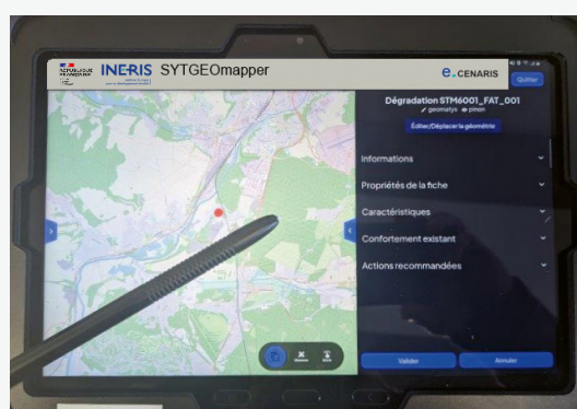
Exemple d'application pour saisie de données d'inspection visuelle via une tablette numérique.
