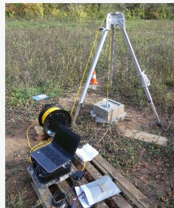
Exemple de système d'acquisition sonar pour inspection en forage.
