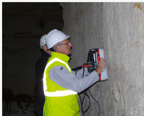
Système d'acquisition Radar du Cerema.
