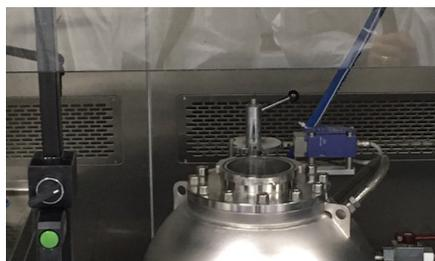
Bonbonne d'essai d'explosion des nanopoussières
