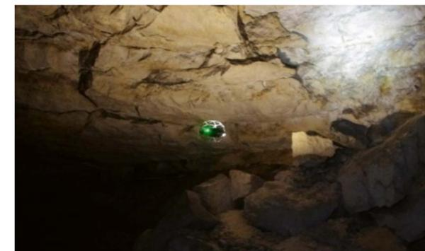
**Figure 12 :** levés par photogrammétrie d'un pilier dégradé (Cerema).
