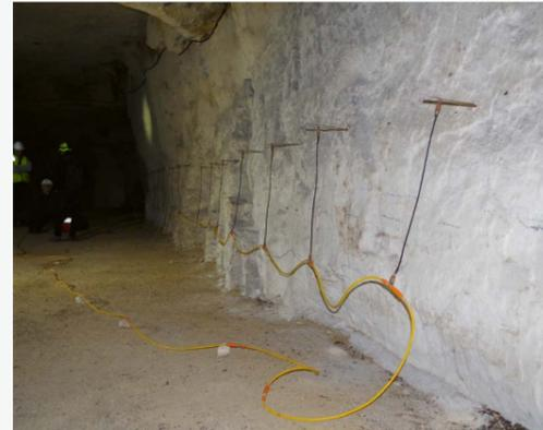
Système d'acquisition électrique sur un pilier.
