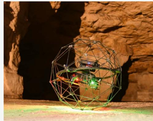
Exemple d'une caméra sur drone volant (Elios 2 de FLYABILITY).
