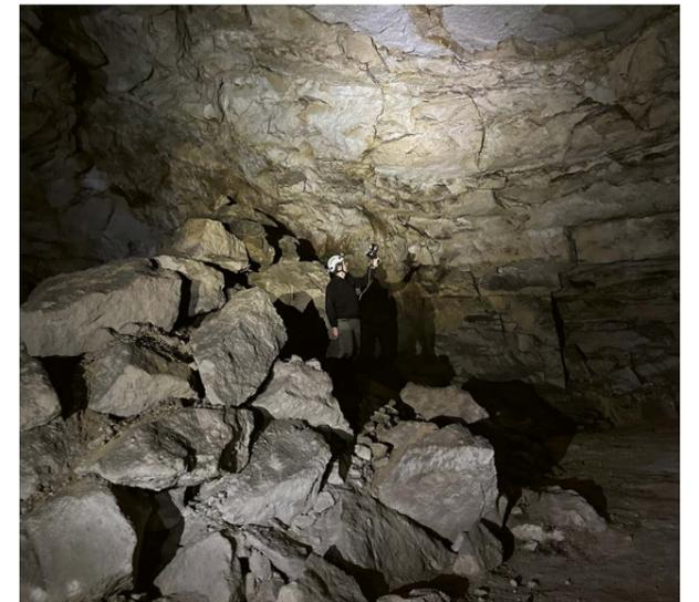
**Figure 9 :** levés par scanner laser terrestre d'une zone de chambres et piliers (Ineris).
