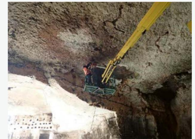
Radargrammes et application de la méthode, par nacelle, au toit d'une cavité.
