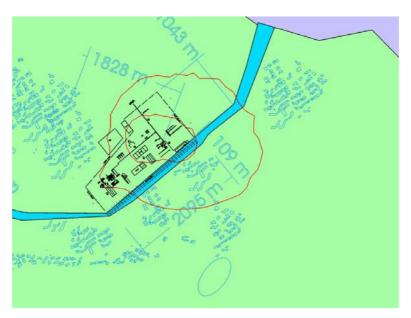
Figure 5 : Variabilité des résultats dans le calcul du risque individuel — Minimum et maximum calculés pour la courbe d'isorisque  $10^{-5}$  /an
