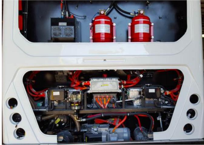
Figure 17 : Arrière du bus BYD avec en partie haute de l'image le système d'extinction embarqué<sup>54</sup>
