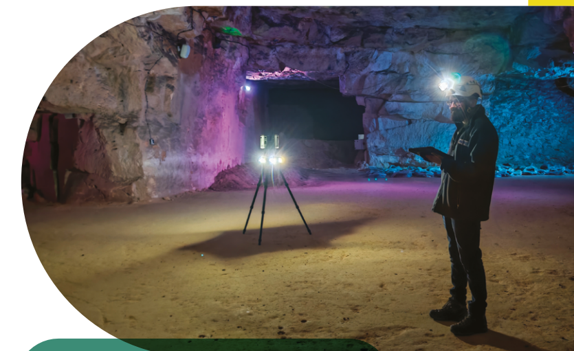
Scanner-laser 3D au sein de la plateforme expérimentale et pédagogique (Saint-Maximin)
