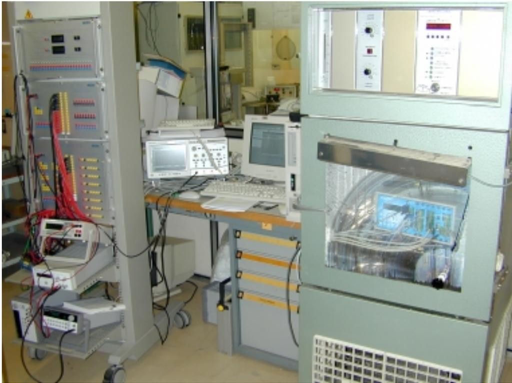
Photo n°1 : réalisation des tests de conformité de la station OP@L en étuve climatique
