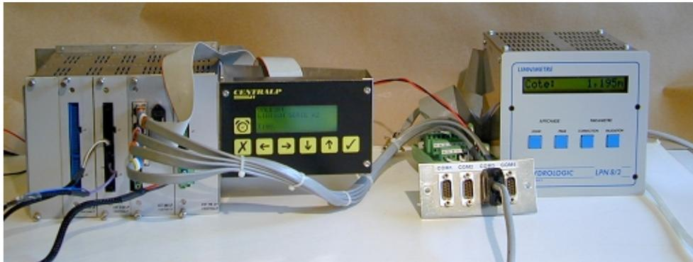
Photo 4 : LPN8 raccordé à la station NOE2000 via câble série (SubD25 – dB9)
