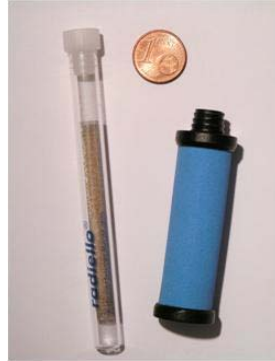
Figure 3 : Tube à diffusion avec son support de prélèvement
