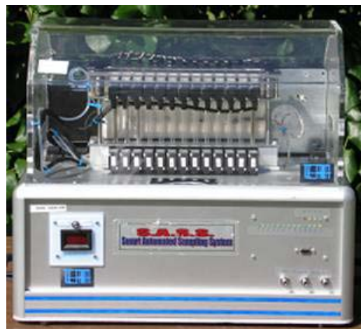
Système de prélèvement transportable fonctionnant sur secteur permettant de réaliser des prélèvements séquentiels
