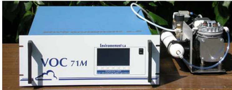
Figure 4 : Exemple de système de mesure en continu des BTEX
