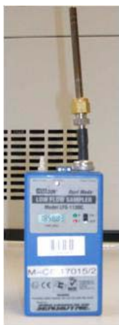
Système de prélèvement portable fonctionnant sur batterie (autonomie 8 heures)
