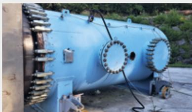
Chambre d'essai de 10m<sup>3</sup> permettant tester la sécurité du matériel industriel lors d'explosions accidentelles
