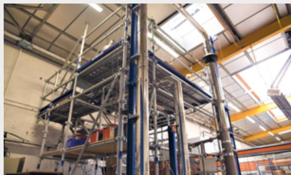
Banc d'essais pour tester les appareils de chauffage domestique fonctionnant au bois
