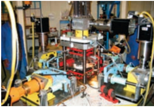
FIGURE 1 DISPOSITIF EXPÉRIMENTAL ACCUEILLANT UN ÉCHANTILLON FRACTURÉ dont le pourtour et le forage d'injection d'eau sont imperméabilisés ; la fracture comporte un collier amovible
