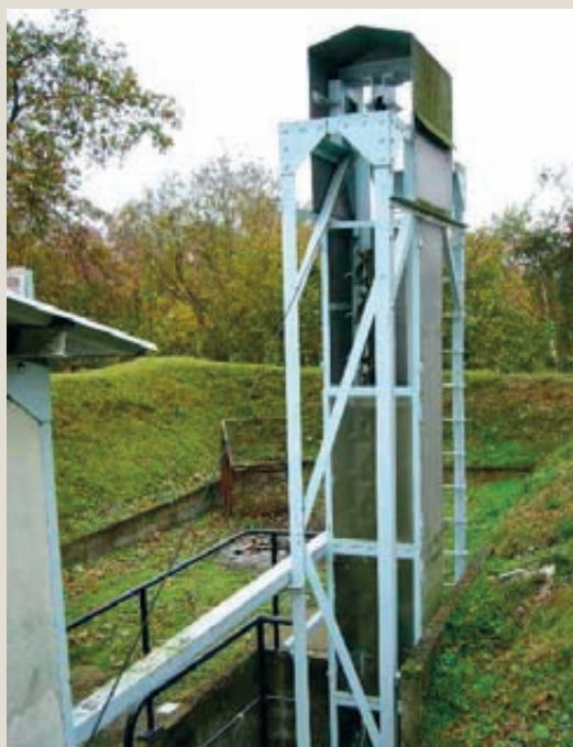
Installation pour essai de chute sur les stockages d'énergie électrique.
