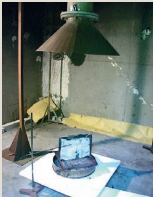
Essai de combustion d'une batterie Li-ion.
