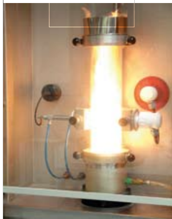
Mesure de l'énergie minimale d'inflammation d'un nuage de poussières.
