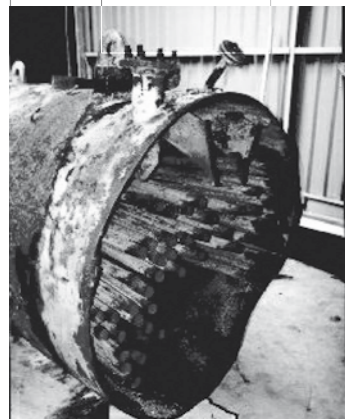
Élément de chaudière propulsé par effet fusée.
