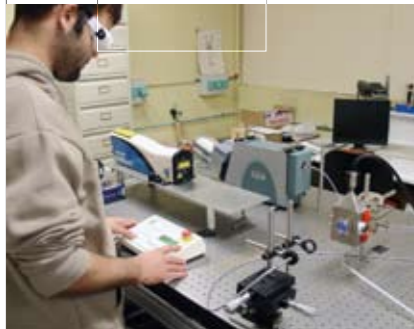
Détection de la présence de nanoparticules dans l'air par laser à impulsion.
