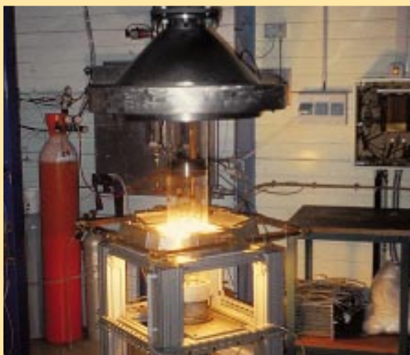
Essais de feu sous-ventilé de TDI au moyen du calorimètre de Tewarson (FPA).
