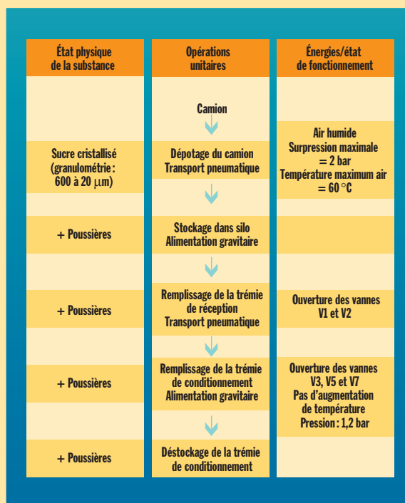
Figure 2 - Analyse fonctionnelle/d'état d'un système de déchargement pneumatique.
