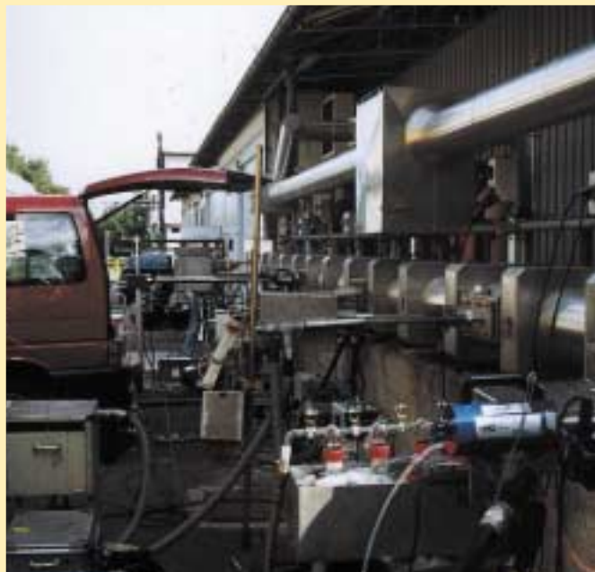
Banc d'essai à l'émission. A chaque trappe est affecté un équipement de mesure multipolluant.
