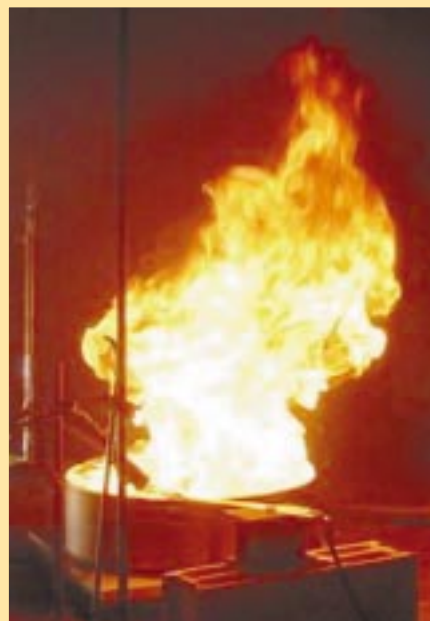
Feux de pyridine. Essais en chambre 80 m 3 .
