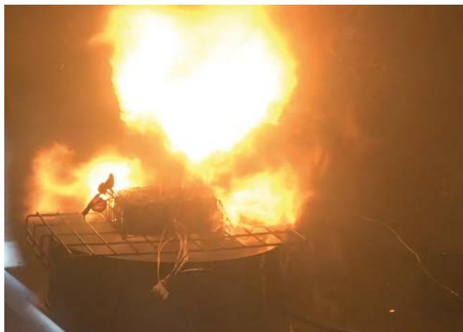
Essai d'emballement thermique, réalisé à l'Ineris, suivi d'une extinction par sprinklage sur un module Li-ion.
