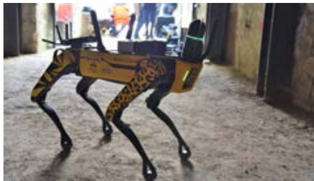
Robot-chien et Lidar (BLK-Arc -Leica monté sur Spot – Boston Dynamics )
