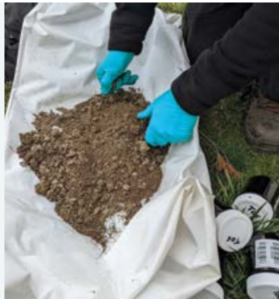
Prélèvement de sol superficiel dans un parc public à la suite d'un incendie sur un centre de tri de déchets.
