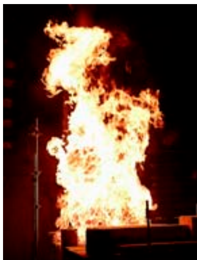
Essai sur batteries lithium-ion.
