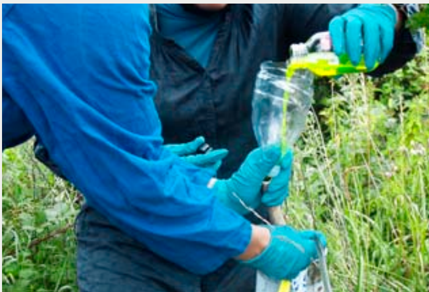
Essai de traçage permettant de caractériser l'hydrogéologie au droit du site pilote retenu dans le projet ANR Nanofreses.
