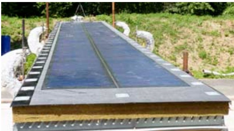
Essai d'inflammation sur panneaux photovoltaïques.
