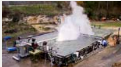
Bassin expérimental pour l'étude de déversements de gaz liquéfiés et de liquides.
