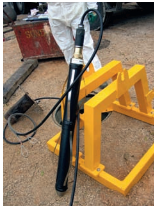
Sonde microsismique tridirectionnelle pour la surveillance de la stabilité de zones à risque d'effondrement.
