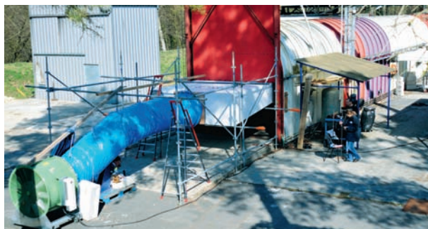
Essai en galerie incendie de l'influence d'accélérateurs sur la stabilité d'une nappe de fumée en cas d'incendie en tunnel routier.
