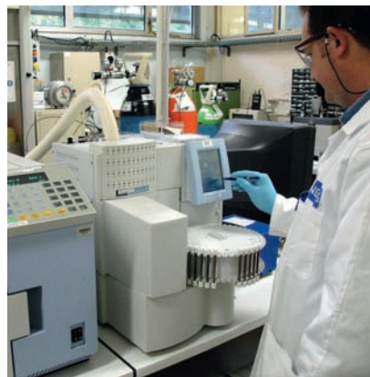
Analyse de COV par thermodésorption et chromatographie en phase gazeuse.
