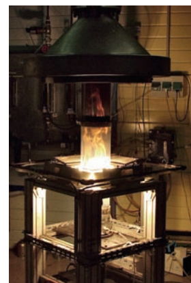
Combustion de polymère PA6 (contenant 1 % de nanotubes de carbone).
