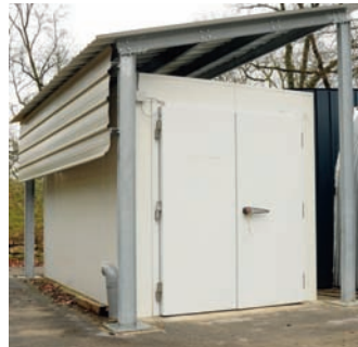
Banc d'essai (20 m 3 ) pour matériels destinés aux très basses températures.
