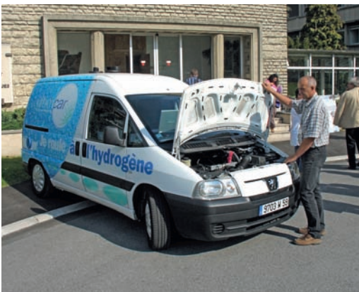
Véhicule à combustion interne fonctionnant à l'hydrogène.
