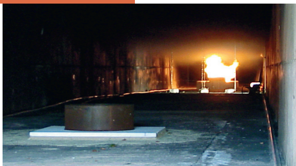
Essai en galerie incendie de l'influence d'accélérateurs sur la stabilité d'une nappe de fumée en cas d'incendie en tunnel routier.
