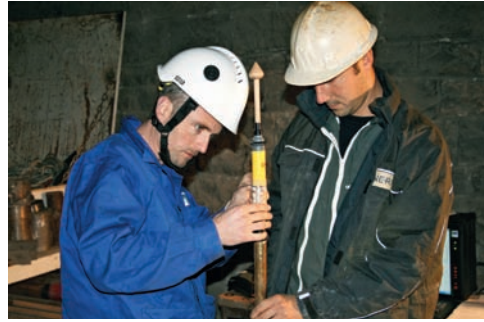
Mesures de contraintes par surcarottage dans le cadre d'une campagne d'essais associant l'INERIS et l'IRSN.
