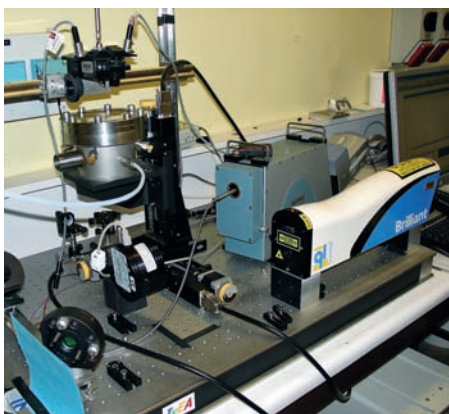
Système de génération de plasma par laser pour la détection de nanoparticules dans l'air ou déposées sur des surfaces.
