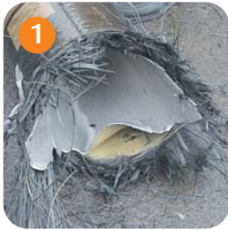
1. Rupture d'une bouteille en composite à cordeau détonant sous 700 bars de pression d'hydrogène. 2. Site industriel classé Seveso.
