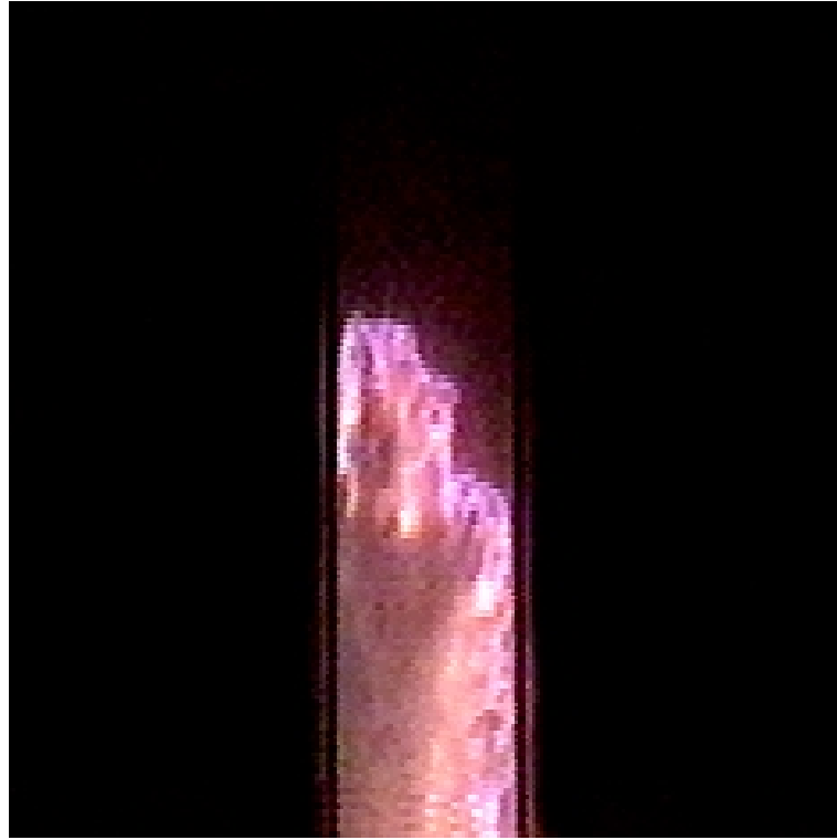
Figure 5: exemple de flamme turbulente se propageant dans un tube vertical (mélanges air-particules de soufre)
