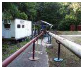
Tube d'explosion (diamètres 10-25-40) de diverses longueurs (3 à 30 m)
