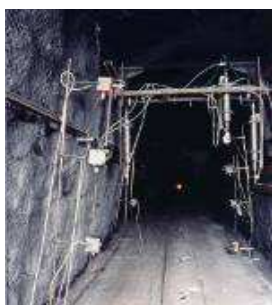
Galerie de 150 m (10 m 2 d'ouverture) pour tests de ventilation et/ou de détecteurs de gaz
