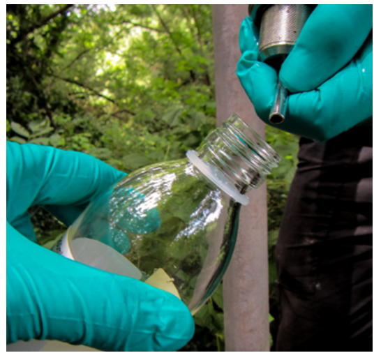
Figure 4 / Utilisation d'une pompe pneumatique à vessie afin de limiter le débit de prélèvement
