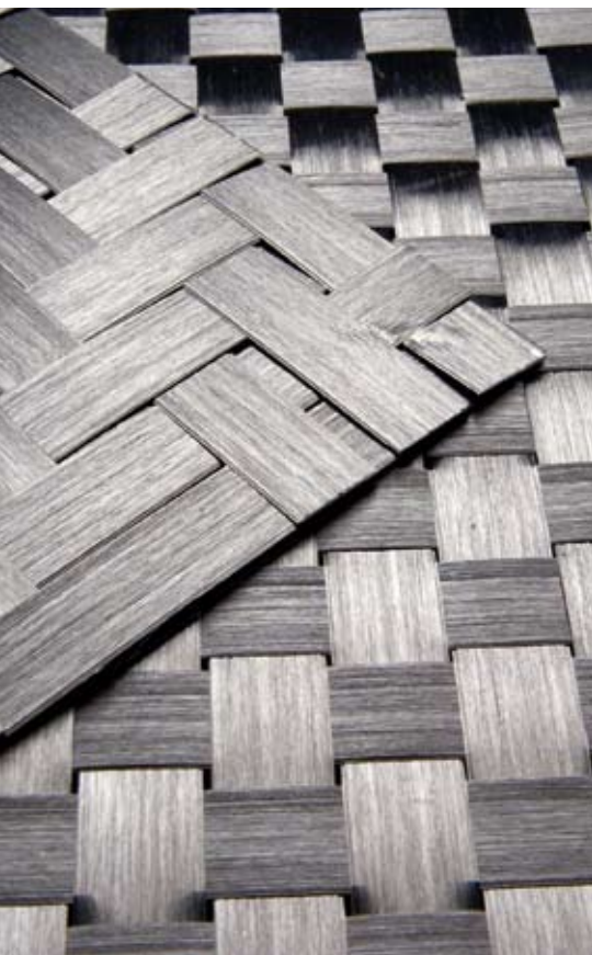
Les fibres de carbone, ici en maillage, servent à la réalisation de nombreuses applications notamment dans le domaine de l'aéronautique ou de l'automobile.
