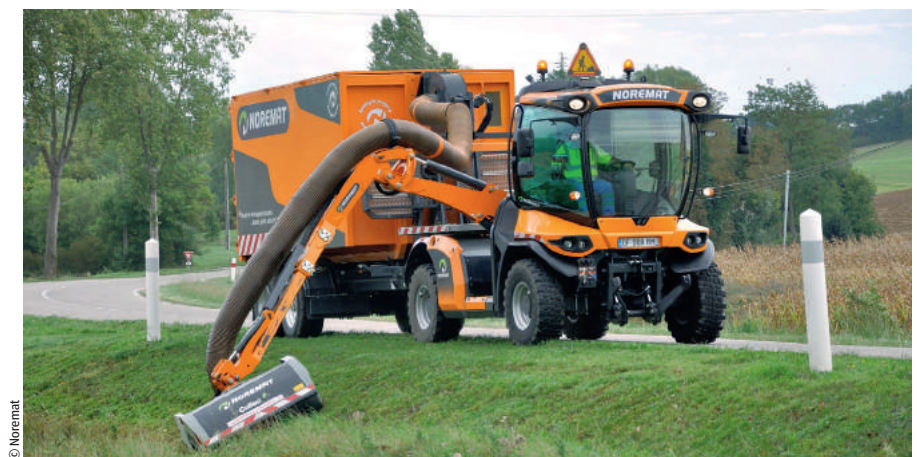
← Le véhicule développé par Noremat, capable de faucher les accotements tout en collectant les déchets verts.
