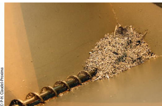
← Les meulures de rectification peuvent être valorisées sous forme de briquettes.
