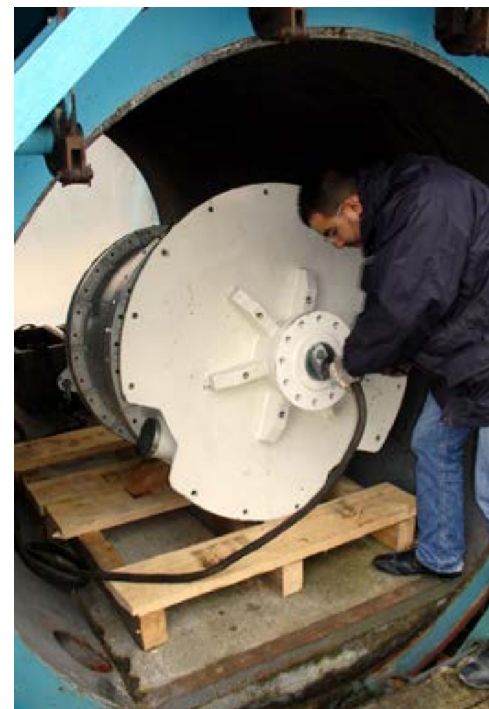
↑ Qualification d'un coffret anti-déflagrant fonctionnant en atmosphère explosible.
