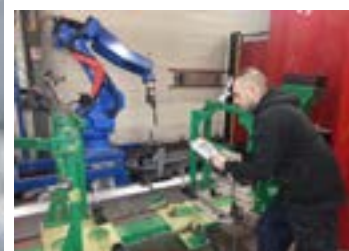
↑ Le robot mesure, prépare et soude les pièces.
