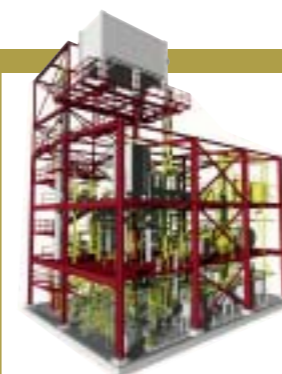
CONCEPTION D'INSTALLATIONS industrielles de tuyauteries en 2D et 3D avec intégration des équipements, des bâtis supports, des chemins de câbles et des accessoires.
