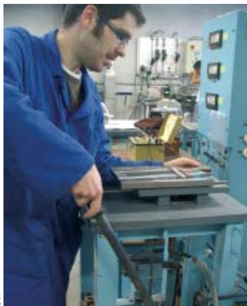
ESSAI DE SOUDABILITÉ pour valider un nouveau procédé.
