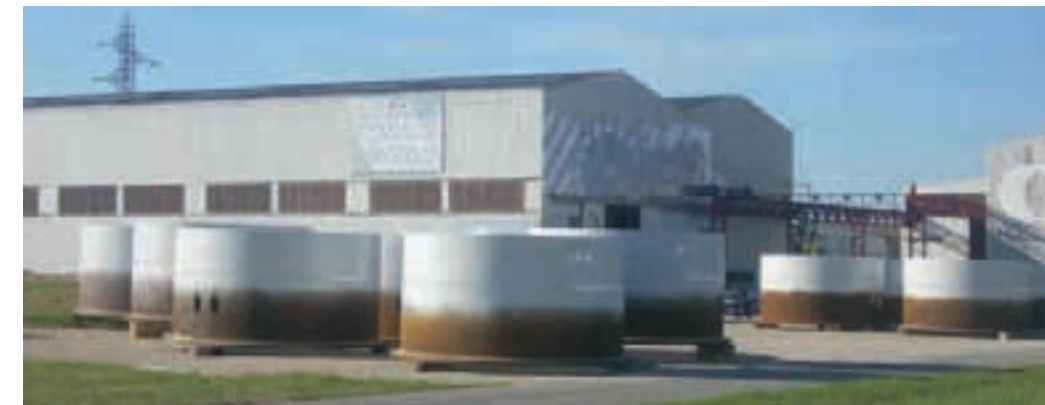
Embases d'éoliennes fabriquées par la société Guerton.
