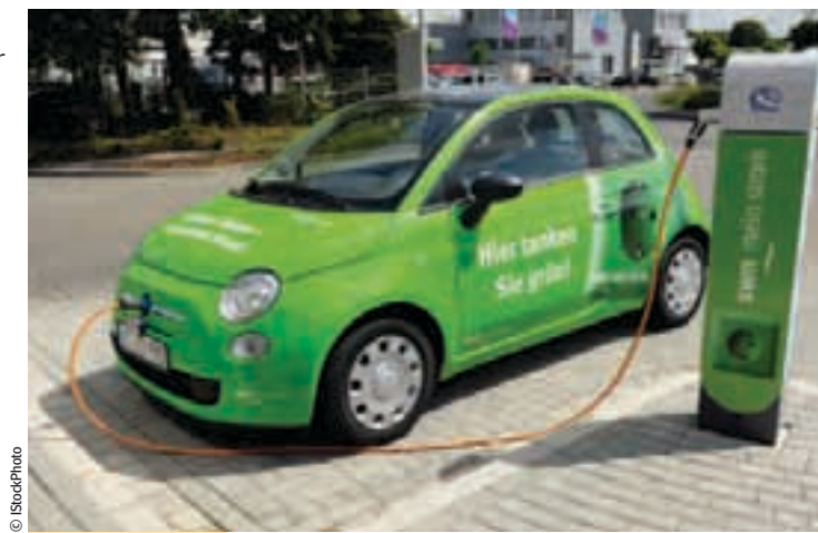
La charge rapide présenterait un risque lorsque la température de la batterie est inférieure à 0° C.
