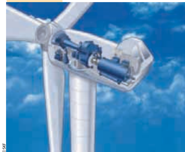
Frein, rotor, roulement, actionneur... l'éolienne, un produit mécanique par excellence.
