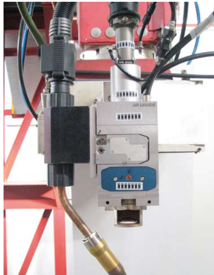
Tête de soudage hybride robotisable développée par Air Liquide
