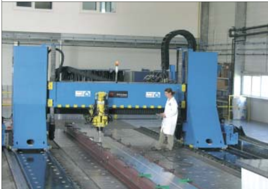
SOUDEGE PAR FRICTION STIR WELDING de profilés en aluminium dans le centre dédié à ce procédé de l'Institut de Soudure.
