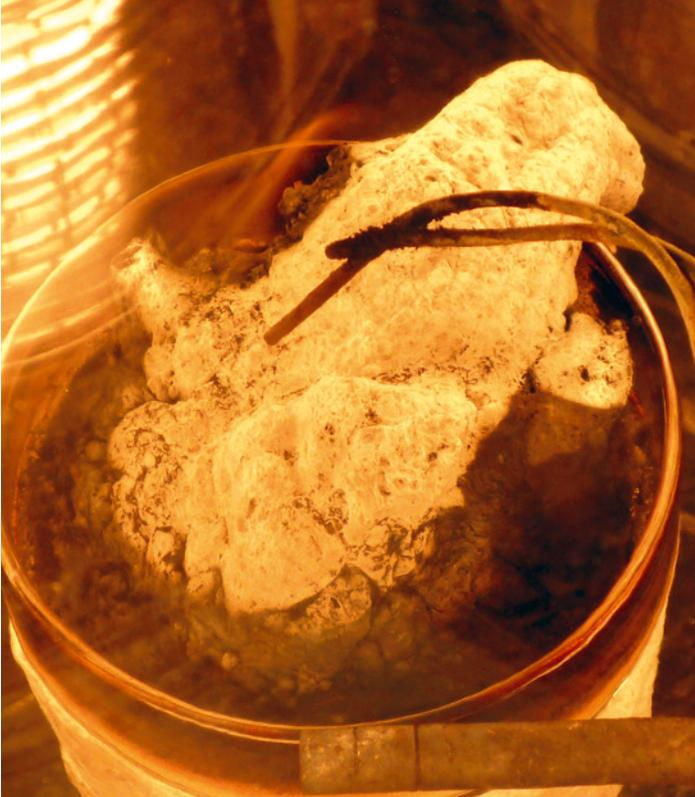
Essais de combustion au calorimètre de Tewarson du Sodium CarboxyMethyl Cellulose (Na-CMC) - un composant largement utilisé dans la formulation des électrodes pour les batteries Li-ion.
