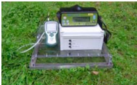
Appareillage pour la détection des fuites de CO<sub>2</sub>.
