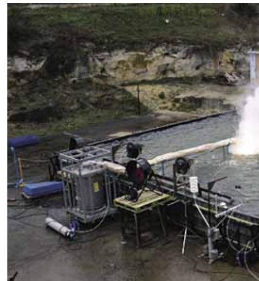
Bassin expérimental pour l'étude de déversements
