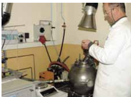
Préparation d'essai d'explosion de nanoparticules dans une sphère de 20 litres
