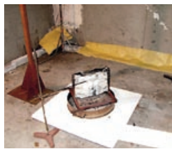
Essai de combustion d'une batterie Lithium ion.
