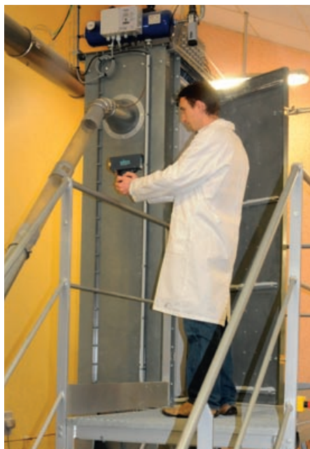
Mesure de champs électrostatiques à l'aide d'un détecteur portable à l'entrée du filtre à manche.
