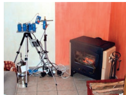
Systèmes de prélèvement des particules et des gaz dans l'air intérieur et appareil de chauffage au bois.
