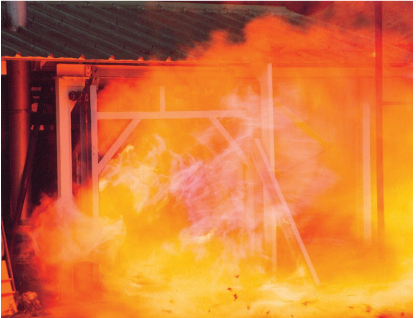
Explosion dans un coffret antidéflagrant d'un mélange air éthylène.
