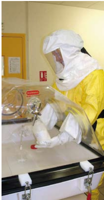
Préparation de nanomatériaux dans une boîte à gants avec protection individuelle.
