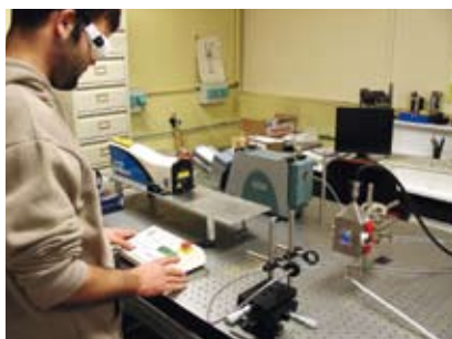
▲ Mesure directe par laser à impulsion, détection de présence de nanoparticules manufacturées dans l'air. ▼
