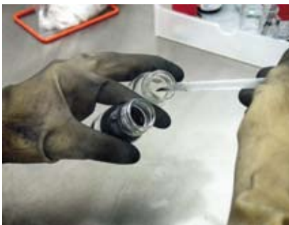
Pesée de nanotubes de carbone sous boîte à gants.
