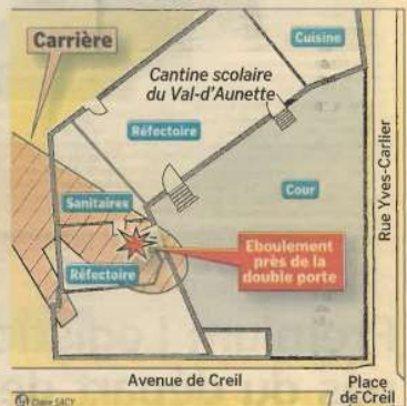
Une des salles du réfectoire est traversée de part en part par une cavité souterraine d'une vingtaine de mètres.
