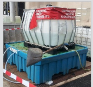
Figure 2 / Conteneur GRV endommagé par surpression interne liée à l'échauffement et la décomposition du peroxyde organique contenu.
