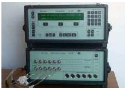
Figure H. Dispositif de mesure du renouvellement d'air par gaz traceur à gauche l'analyseur, le multiplexeur et à droite le PC de commande et la bouteille de gaz
