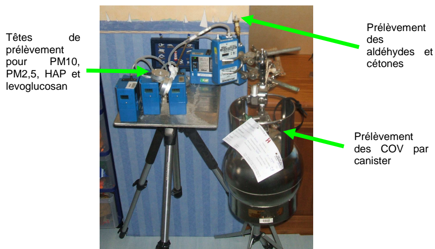
Figure C. Prélèvement des particules et des composés organiques en air intérieur
