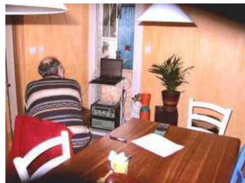
Figure H. Dispositif de mesure du renouvellement d'air par gaz traceur à gauche l'analyseur, le multiplexeur et à droite le PC de commande et la bouteille de gaz
