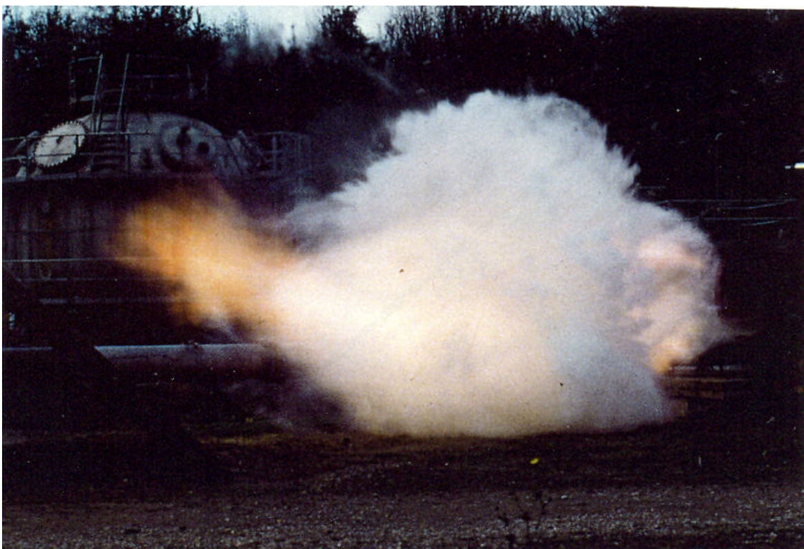
photo 8 : Explosion de poussière dans une canalisation de DN1000 sans barrière d'extinction [02]
