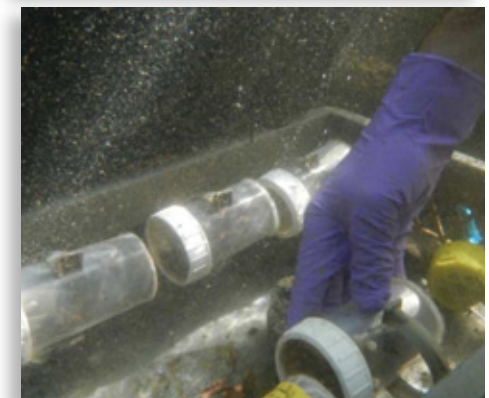
Avec le bioindicateur Gammare, est développée une méthode basée sur l'encagement d'organismes in situ comme indicateurs de la toxicité des milieux.
