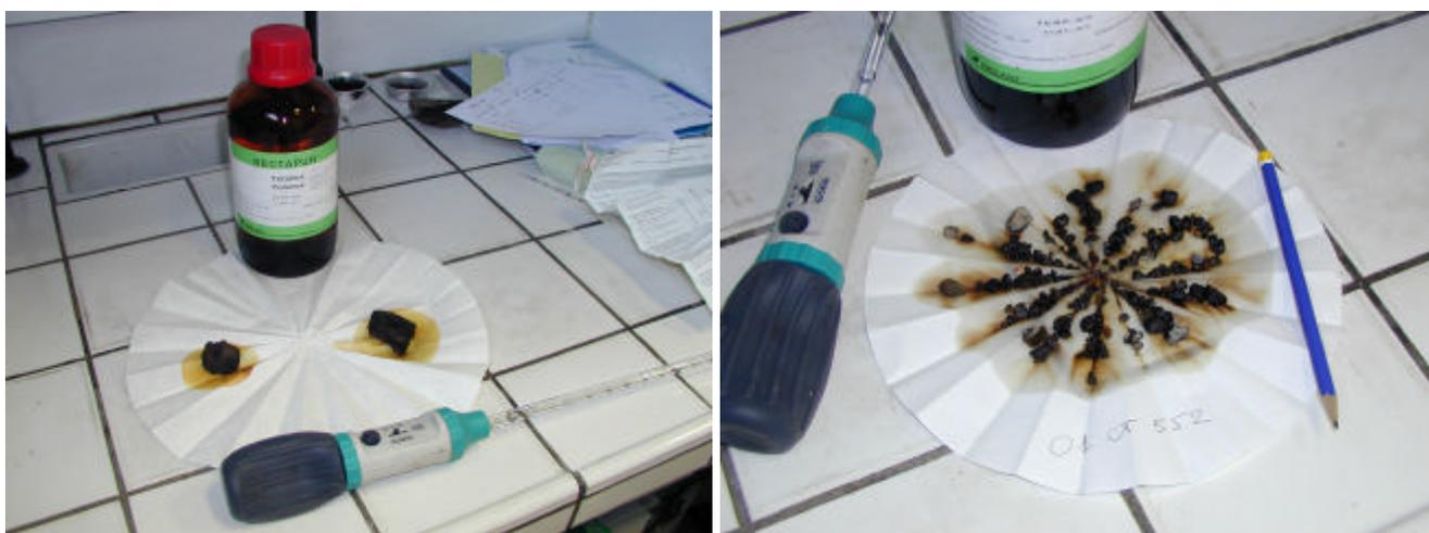
*Photo 19 : Résultats des essais de la tache au toluène sur des débris d'enrobés échantillons 01CT886 et 01CT552.*
