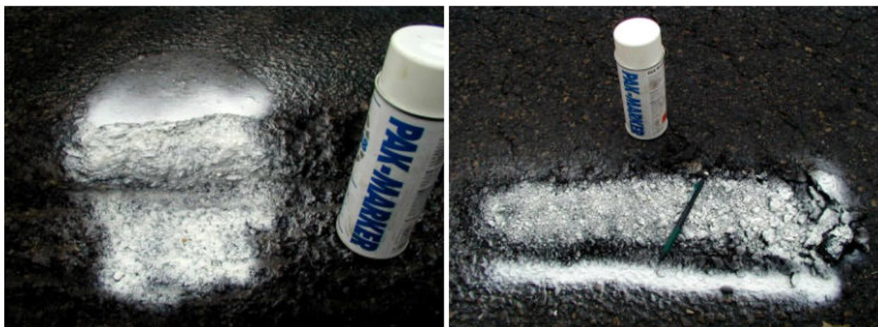
*Photos 11 et 12: Essais au PAK Marker sur des croûtes d'enrobés déposées en décharge (44 Donges), échantillons 01CT874 et 01CT876.*
