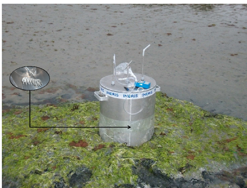
Photographie 1 : chambre d'échantillonnage sur les algues vertes en décomposition
