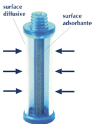
Figure : Principe d'un échantillonneur passif RADIELLO®
