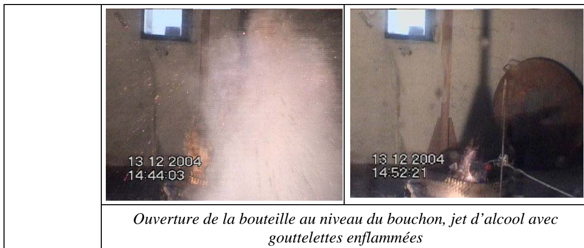
Figure 18 : Différentes phases observées lors de la combustion des bouteilles plastiques contenant de l'alcool à 13% Vol.
