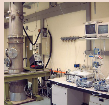
La section de mesure, équipée de 4 brides de 3 pouces
