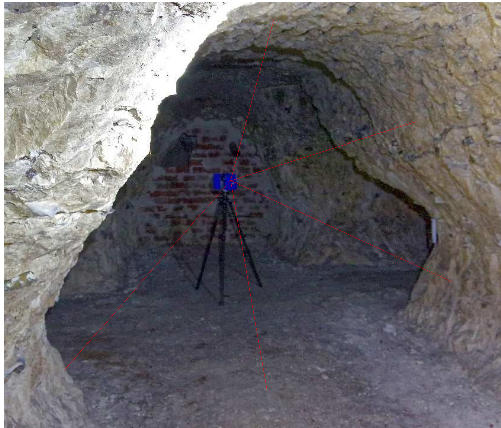
Maillage direct des points acquis par le scanner
