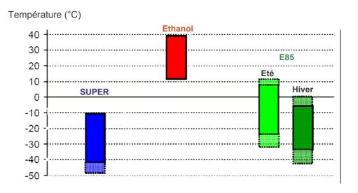
Figure 1 : Gammes de température d'explosivité des mélanges vapeurs/air en enceinte fermée (Source : SRSA)
