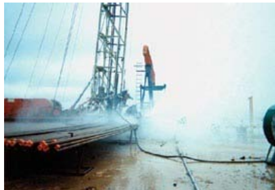
Figure 22 : Conséquences en surface d'un blow-out (Skinner, 2003)
