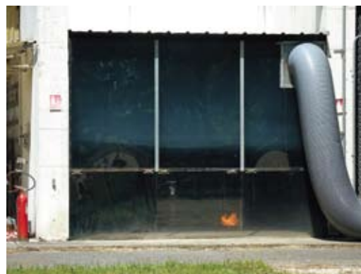
Inflammation d'un nuage stratifié d'hydrogène.
