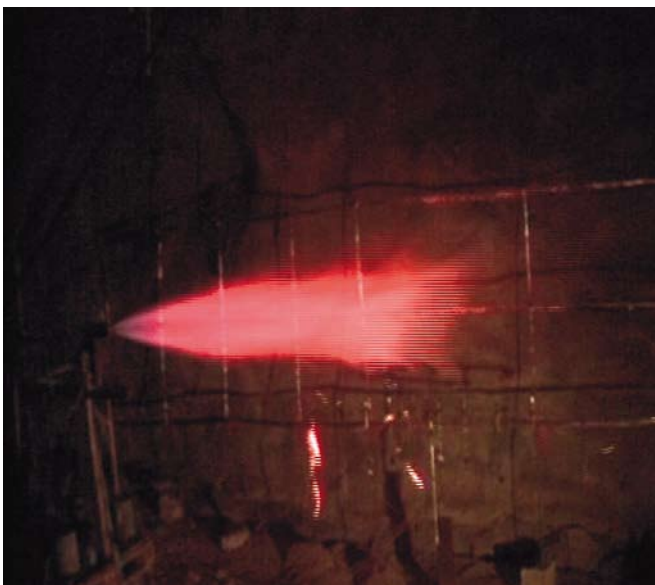
Essai de feu torche d'hydrogène dans le cadre d'études sur le transport de l'hydrogène énergie (projet HYDROMEL).
