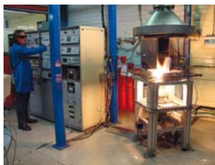
Essai à niveau constant de combustion d'huile de maïs au calorimètre de Tewarson.
