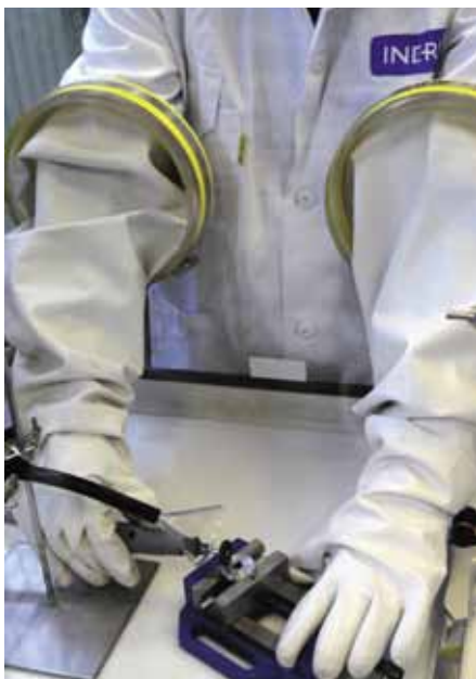
Expérience de vieillissement forcé de nanomatériaux
