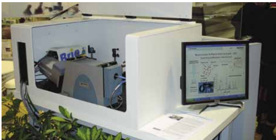
Maquette pour démonstration du détecteur de nanoparticules LIBS
