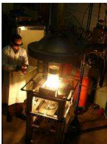
Calorimètre de Tewarson pour qualifier le comportement d'une substance en cas d'incendie (paramètres thermiques et chimiques)
