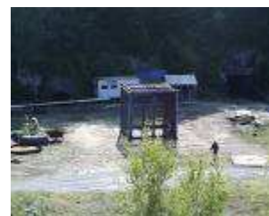
Enceinte pare-éclats pour des essais d'éclatement de structures sous l'effet d'une explosion ou d'un incendie
