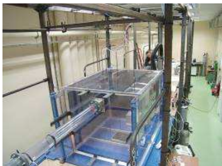
Maquette « froide » de 15 m à échelle 1/18ème pour modéliser des dispersions de gaz chauds (fumées) ou denses (rejets toxiques)
