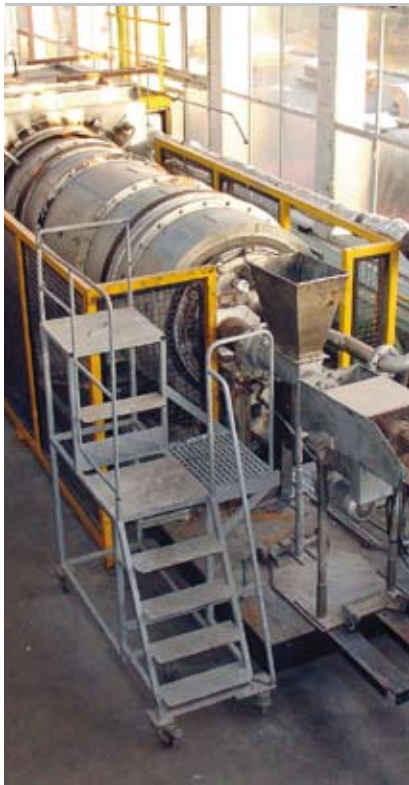
Installation de combustion existante sur laquelle seront installées une alimentation en oxygène en entrée et une ligne de récupération de CO 2 en sortie.
