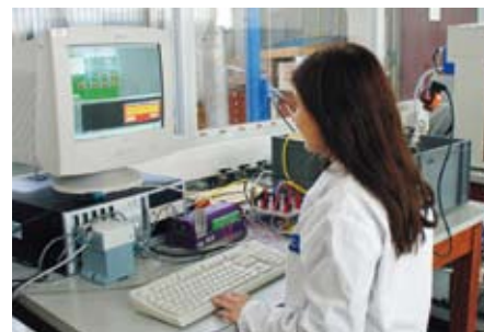
Mesure en parallèle de trois échantillons de charbon à l'aide du porosimètre (Belsorp Mini).
