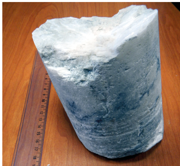
Figure 4 : carotte de gypse albaströïde extrait de l'horizon des Marnes et Caillasses à partir d'un forage carotté en Ile-de-France, échantillon fourni par le Cerema
